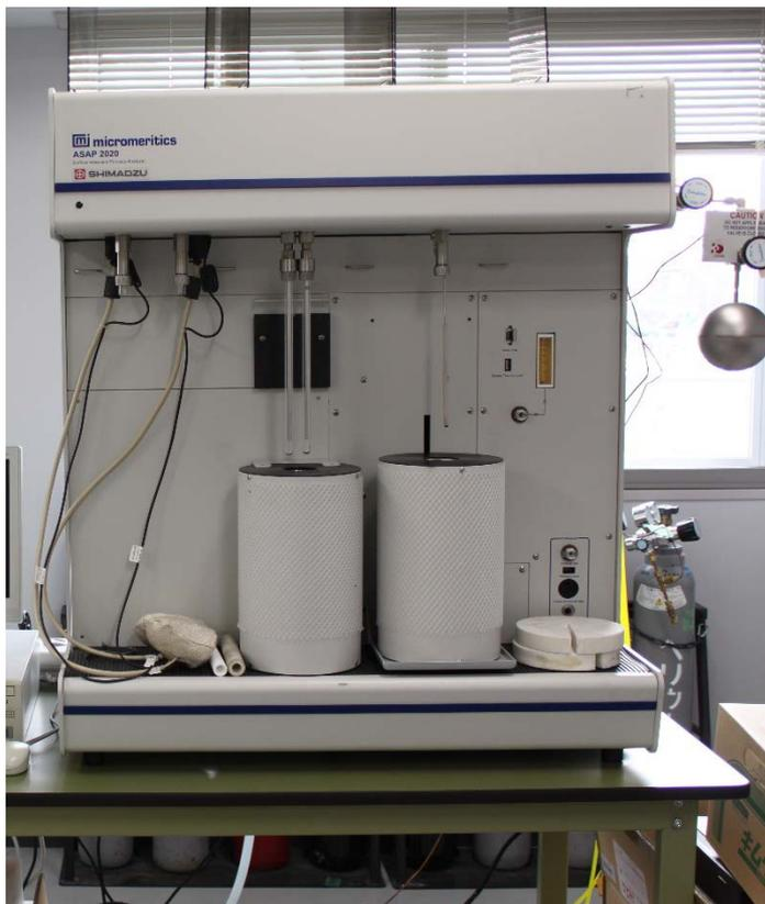
ガス吸着法(BET法)により、窒素吸着を使った多孔性試料の表面積測定を行う!
