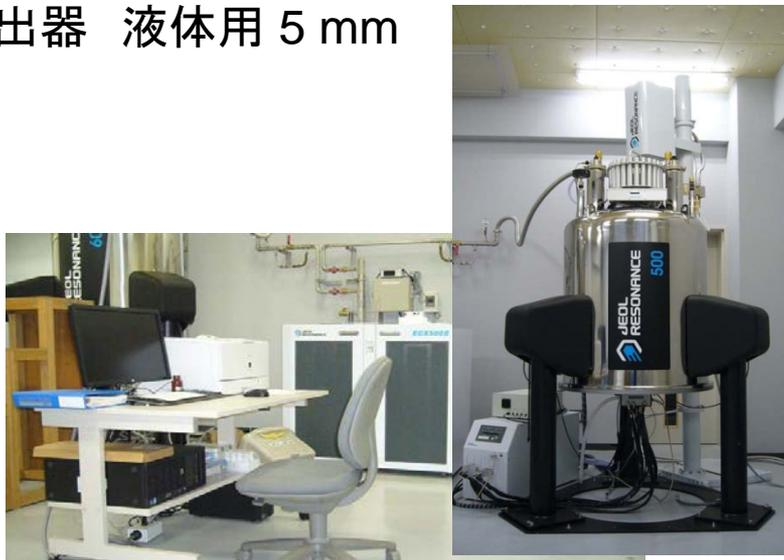
核スピンを持つ元素を測定する機器であり、本装置では主に水素( $^1\text{H}$  NMR) または炭素( $^{13}\text{C}$  NMR)を測定している。有機化合物の同定や構造決定に極めて有用な装置である。
