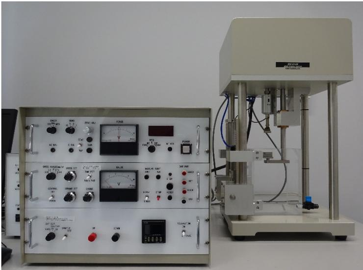
引張りエネルギー・伸張率・回復性などの力学的特性を測定することが可能。低荷重(分解能 0.5g)・低変位(分解能 0.5 $\mu$ m)の精度を持ち、微小領域での測定が可能。毛髪以外にも、紙・シート状樹脂、繊維、ナノファイバーシート、ハイドロゲルシートなども1cm幅で引張り試験が可能(厚みのある試料の測定は不可)。
