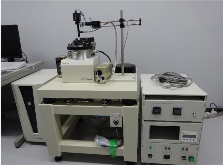
従来の大気型走査プローブ顕微鏡（原子間力顕微鏡）ではできなかった試料周辺の環境を制御しながら測定できる環境制御型SPMです。表面吸着水の影響を最小限に抑える高真空状態での形状観察だけでなく、探針と試料の間の相互作用に基づく物性（摩擦力・磁気力・吸着力・表面電位モード・粘弾性）をマッピングすることができます。
